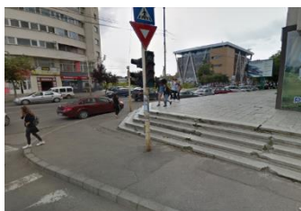
Figură 93 - Imagini reprezentative Bd. Unirii - Lipsa rampelor, prezența rampelor incorect proiectate și blocarea rampelor de mașini parcate
